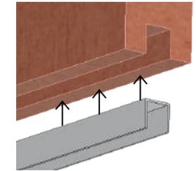
5° Instalação de suporte + perfil ou perfil com abas
